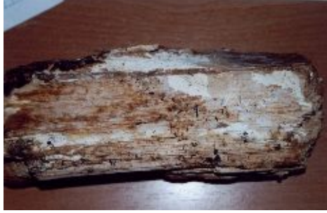
Şekil 5. TEDAŞ Trabzon Bölge Müdürlüğü Arsin Deposunda CCA ile emprenyeli tamamen misellerle sarılmış tel direğinde tespit edilen beyaz çürüklük.
