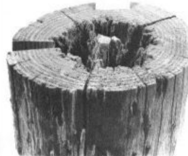
Şekil 10. Tel direklerinde tespit edilen oyuk tipi çürüklük
