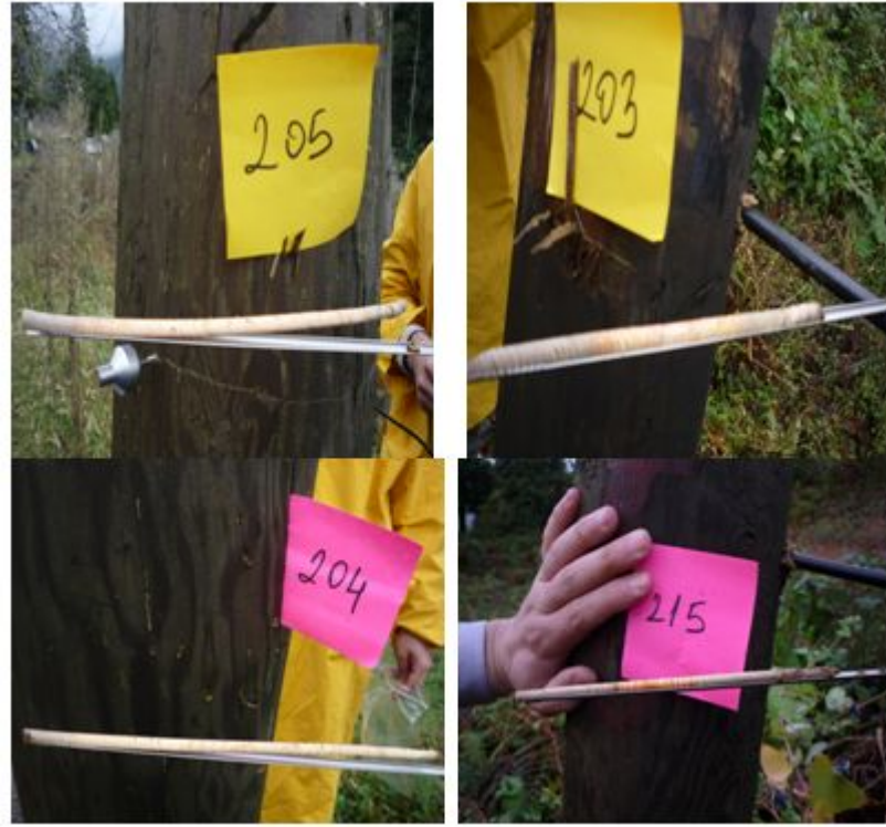
Şekil 14. Artvin-Pamukçular ve Murgul yöresindeki tel direklerinde empenye maddesinin nüfuz derinliği
