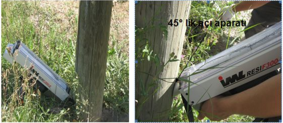
Şekil 4. 45° lik açı aparatıyla tel direklerinin toprakla temas eden kısımlarının da incelenmesi
